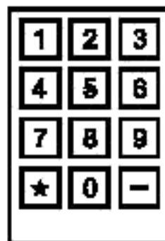
Рисунок F.1 — Пример исполнения рабочей панели клавищного аппарата управления лифтом
