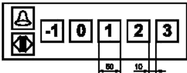
Рисунок G.2 — Пример однорядного исполнения устройства управления с квадратными кнопками
